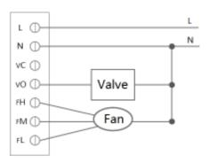
Fig. 2. Honeywell VC4013/VN4013/VS4016 Wiring
