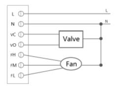
Fig. 3. Honeywell VC6013/VN6013 Wiring
